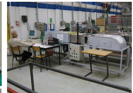
Étude de la distribution des vitesses dans une veine d'air
