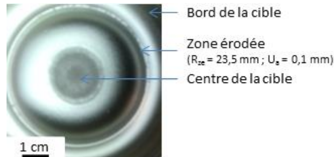
Figure 2-67 : Photo de la cible de nickel utilisée pendant les dépôts. La zone principalement érodée se situe à 23,55 mm du centre ( R_{ze} = Rayon zone érodée, U_a = incertitude de type A pour le rayon mesuré).
