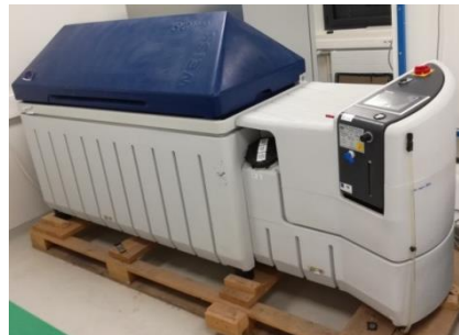
Figure 3-87 : Enceinte de vieillissement utilisée pour réaliser les essais de vieillissement au brouillard salin sur le PRZ.
