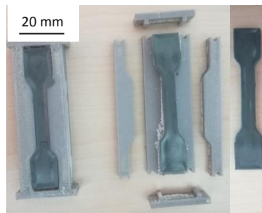
Figure a6-145 : Photos du montage permettant d'obtenir des éprouvettes de traction de peinture.
